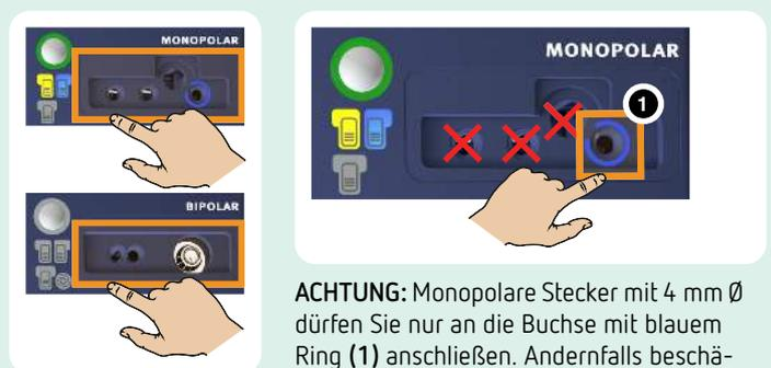
**ACHTUNG:** Monopolare Stecker mit 4 mm Ø dürfen Sie nur an die Buchse mit blauem Ring (1) anschließen. Andernfalls beschädigen Sie das Gerät.
