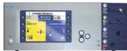
VIO-HF-Chirurgiesystem mit Display für CUT- und COAG-Einstellungen
